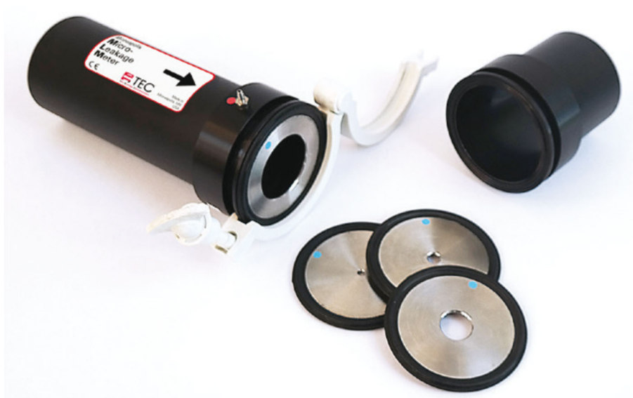
Figur 4. Enhed til bestemmelsen af luftstrømmen der pumpes ud af prøvevolumenet. Luftstrømmen over blænden måles.
