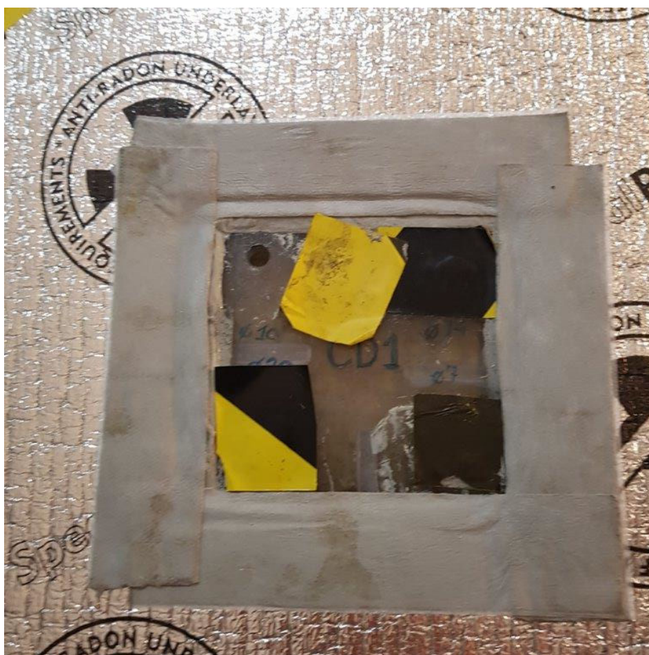
Figur 5. Blændeskive placeret i oversidemembran. De enkelte huller kan blændes med tape, hvorved forskellige kombinationer af åbninger kan skabes.
